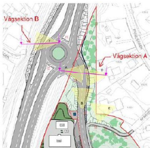
Figur 15. Översiktskarta som visar på kritiska punkter för störningar från ljus. Illustration: Uppsala Teknikprojektering
